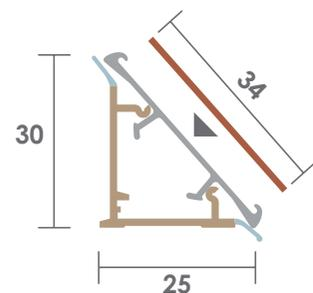
Composta da un profilo in materiale plastico coestruso da fissare al piano e da un profilo di finitura in alluminio pannellabile. Elevata resistenza al calore e all'umidità.
